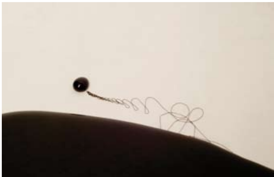
Ensayo de un betún de baja temperatura de extendido en el Centro de Tecnología de Repsol.
