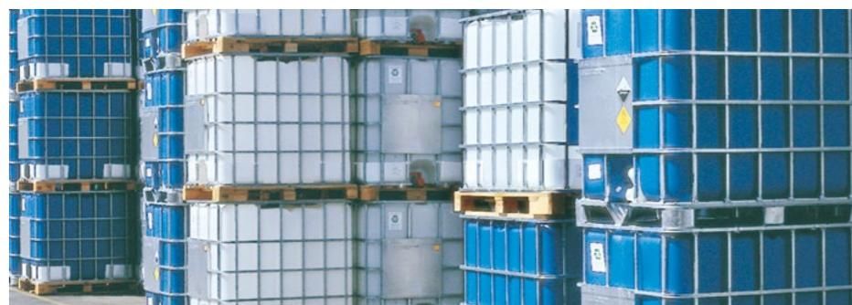
Los grados de alto peso molecular para envases para el transporte de materiales peligrosos y agresivos son más ligeros, con alta resistencia al cracking y rigidez que permiten ahorro de material
