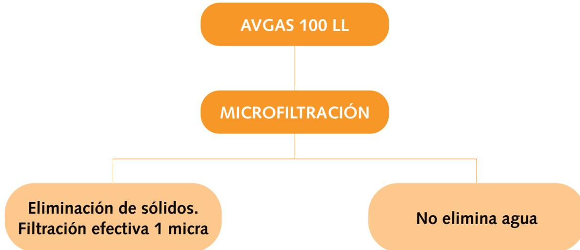
Agua y AVGAS 100 LL tienen densidades muy diferentes. El agua decanta con facilidad y no es necesaria su eliminación por filtración.
