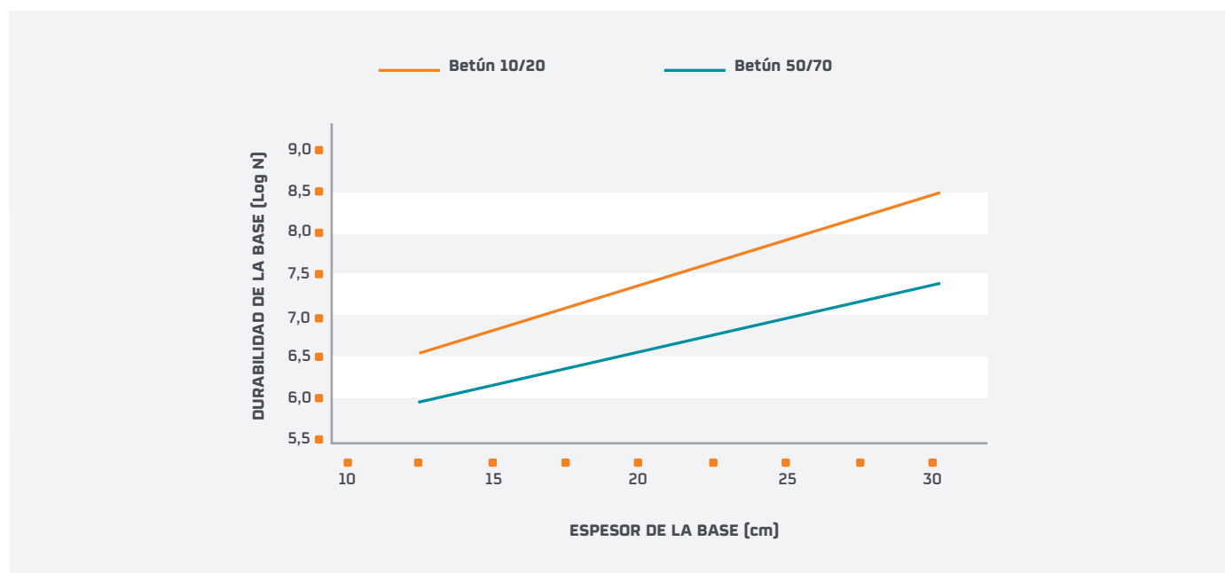
Figura 1. Comportamiento estructural. Datos orientativos, no contractuales, y no sujetos a especificación.
