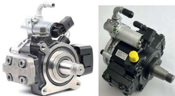
Esta bomba, aunque tenga marca Continental se fabrica por SIEMENS. Se ha usado o se usa en diferentes modelos de vehículos AUDI, SEAT, SKODA, VW.
