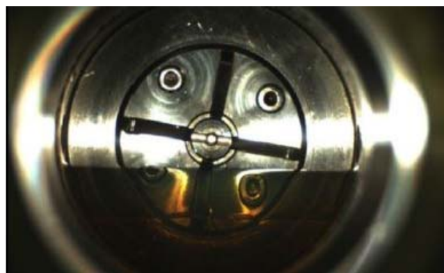
Ensayo de visualización de interfase líquido-vapor. Interpretación de volumetría mediante software integrado
