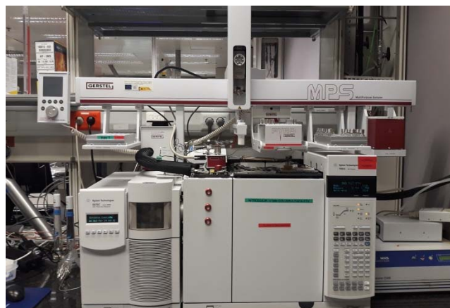
Sistema GC-MS con muestreador automático, robot de preparación de muestras y módulo para pirólisis
